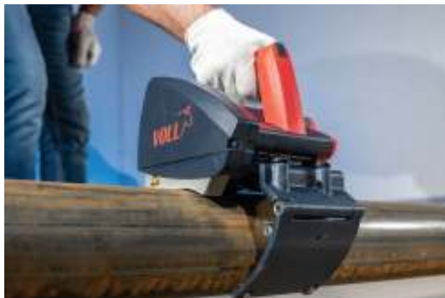
Надёжная фиксация на трубе
