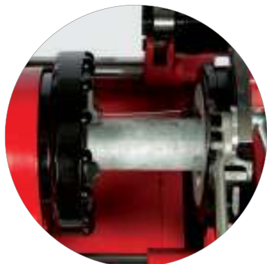
Надёжная фиксация трубы в зажимном патроне
